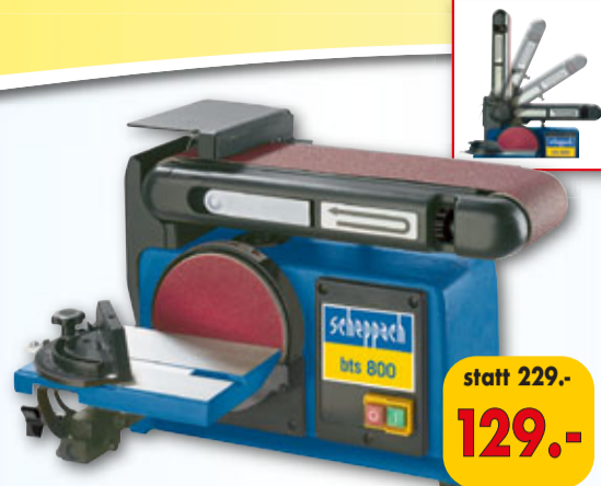
Scheppach Profi Band- und Tellerschleifer bts 800 für den schnellen und exakten Schliff. Das Schleifband ist stufenlos von der Horizontalen in die Vertikale verstellbar. Der um 45° schwenkbare Schleiftisch kann am Band wie am Scheibenschleifer (Ø 150 mm) montiert werden, Schleifauflage Band 280 x 100 mm, Bandlänge 914 mm, 230 V. Best.-Nr. 80 08859
