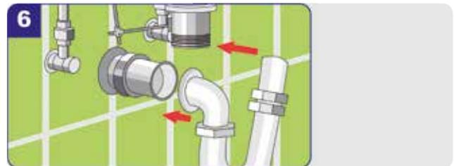
Den Siphon auf das Abflussrohr stecken und mit dem Ablaufventil verbinden. Alle Schrauben noch mal auf Festigkeit prüfen.
