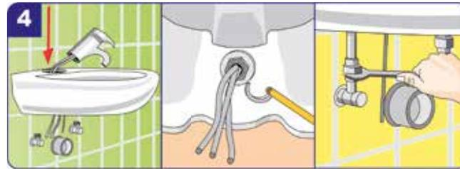
Bei der Montage der Armatur einen Dichtungsring auf das Hahnloch auf der oberen Beckenseite legen. Armatur durch das Loch führen. Von der Unterseite einen Dichtungsring dagegen legen und die Überwurfmutter über das Armaturgewinde schieben und festdrehen. Die Flexschläuche, die zuvor bereits an der Armatur befestigt wurden an die Eckventile anschließen.
