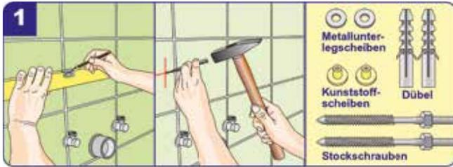
Bohrlöcher mittig über dem Abfluss anzeichnen und mit einem Körner leicht ankörnen, damit der Bohrer beim Bohren nicht abrutscht.
