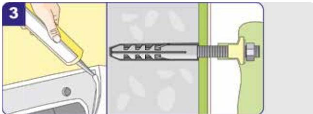
Das Becken sollte auf der Rückseite mit Sanitärsilikon versehen werden, um Spannungen zu vermeiden. Nun das Becken über die Stockschrauben und danach die Kunststoffscheiben über die Stockschrauben schieben, die Metallunterlegscheiben nachlegen und die Muttern abwechselnd anziehen, um Spannungen zu vermeiden.
