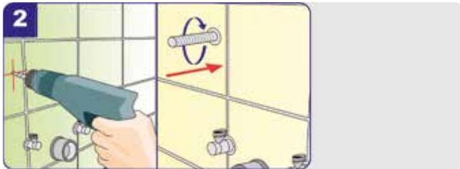
Für die Bohrungen (mind. 85 mm tief) sollte ein Steinbohrer verwendet werden. Beim Durchbohren der Fliese mit langsamer Drehzahl und ohne Schlag arbeiten. Die Stockschrauben werden mit dem Gabelschlüssel in die Dübel eingeschraubt bis das grobe Gewinde nicht mehr sichtbar ist.
