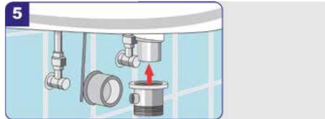
Montage des Ablaufventils: Das Ventiloberteil mit einem Dichtungsring bestücken und von oben in den Ablauf einsetzen. Das Unterteil an das Oberteil ansetzen und miteinander verbinden.
